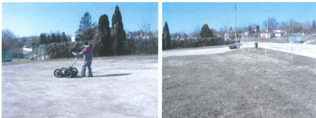
8.-9. kép: A földradar mérések képei.
