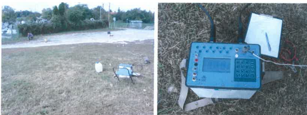
6.-7. kép: A rétegszelvényezés műszere.
