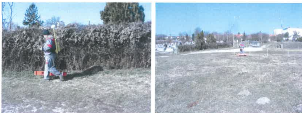
2.-3. kép: Az elektromágneses vezetőképesség mérés végrehajtása.
